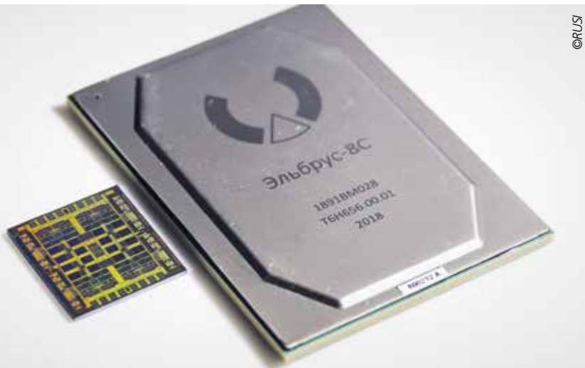
Russischer Chip ELBRUS 8C. Im Test der IT-Division der SBERBANK scheiterte er 2021 im Vergleich mit INTELs Xeon Gold 6230 bei 84 Prozent der funktionellen Testfälle. Fazit: Nicht für Alltagsaufgaben innerhalb des Unternehmens geeignet.
